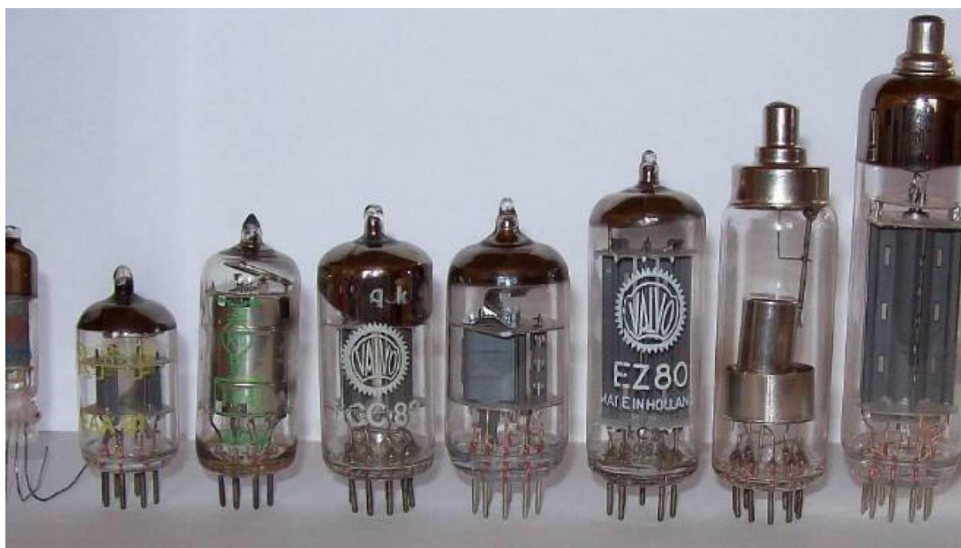
Figura 1 - Exemplo de tubos de vácuo utilizados pelos computadores da primeira geração
